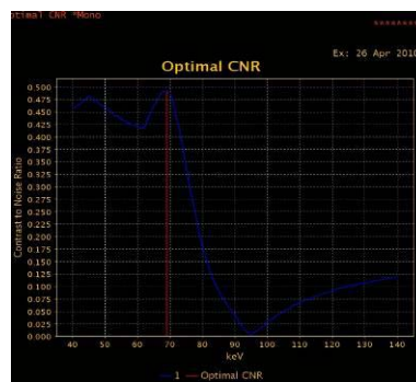
(b) 红线对应纵坐标——最佳 CNR 值, 红线对应横坐标——最佳单能量值
