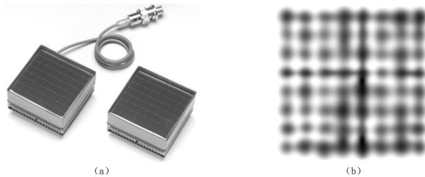
图 11 位置灵敏光电倍增管和像点图
