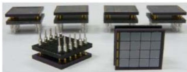
图 15 SensL 公司生产的 SPM 探测器
