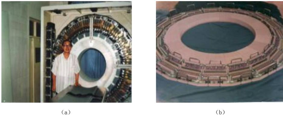
图 8 PET 机架和探测器环
