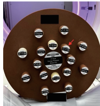
图 1 Gammex CT 体模的照片,箭头所指是代表标准肝脏密度(1.06 g/cm 3 )的插入物
