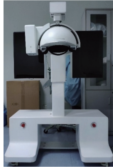
图 5 头盔式全数字 PET 原型机 Fig.5 All-Digital helmet PET prototype
