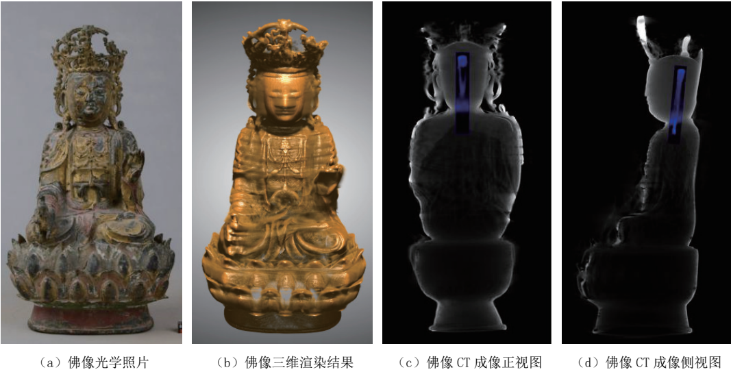
图 2 青铜器佛像的 CT 实验结果 Fig.2 CT experimental results of bronze Buddha statues
