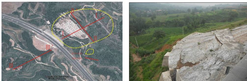
图4 物探测线布置图及现场滑坡照片
